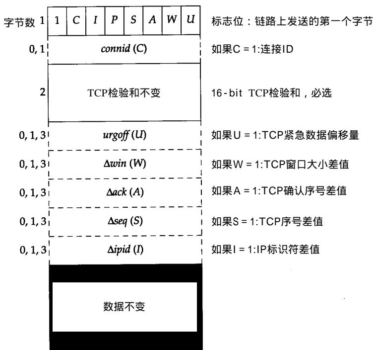
图29-34 压缩后的IP/TCP首部格式
